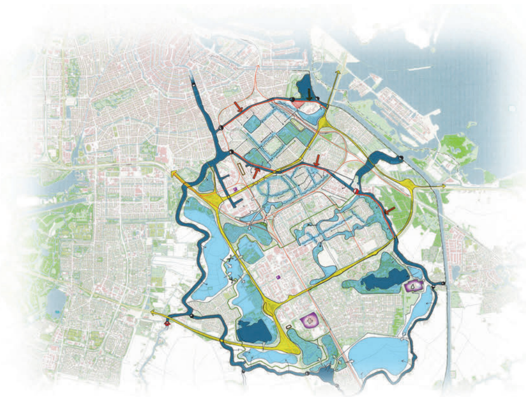
Stap 3 voor overstroming vanuit regionaal watersysteem: aanvullende compartimentering, geleiding en vluchtplaatsen
