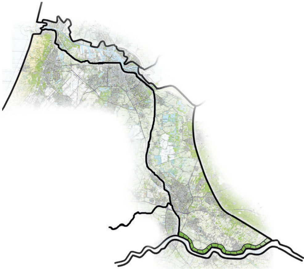
Door de Lekdijk te versterken wordt de kans op een overstroming in Amsterdam sterk verkleind
