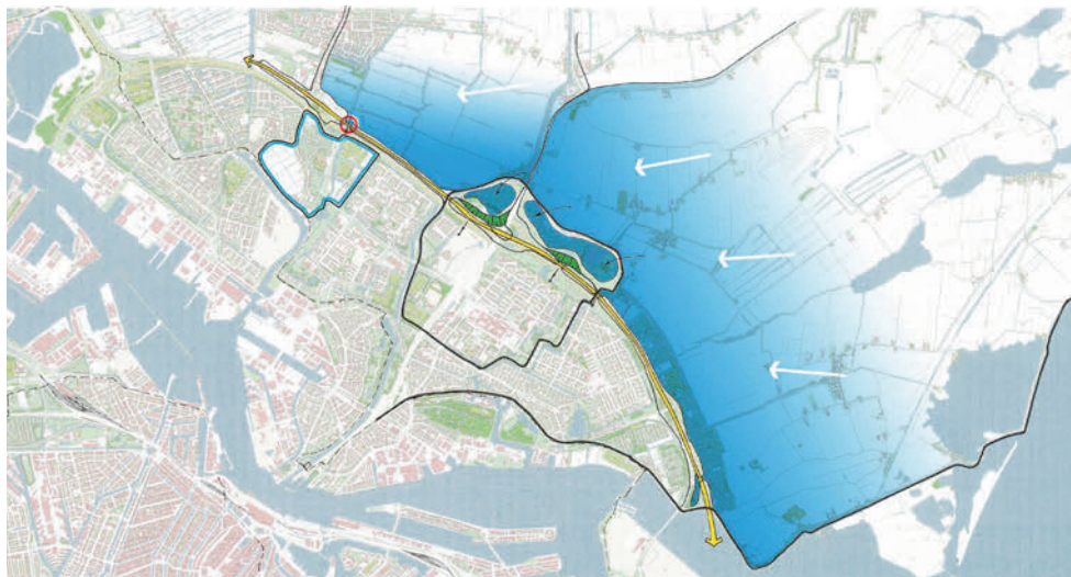
Ring A10 als nieuwe waterkering bij overstroming Waterland
