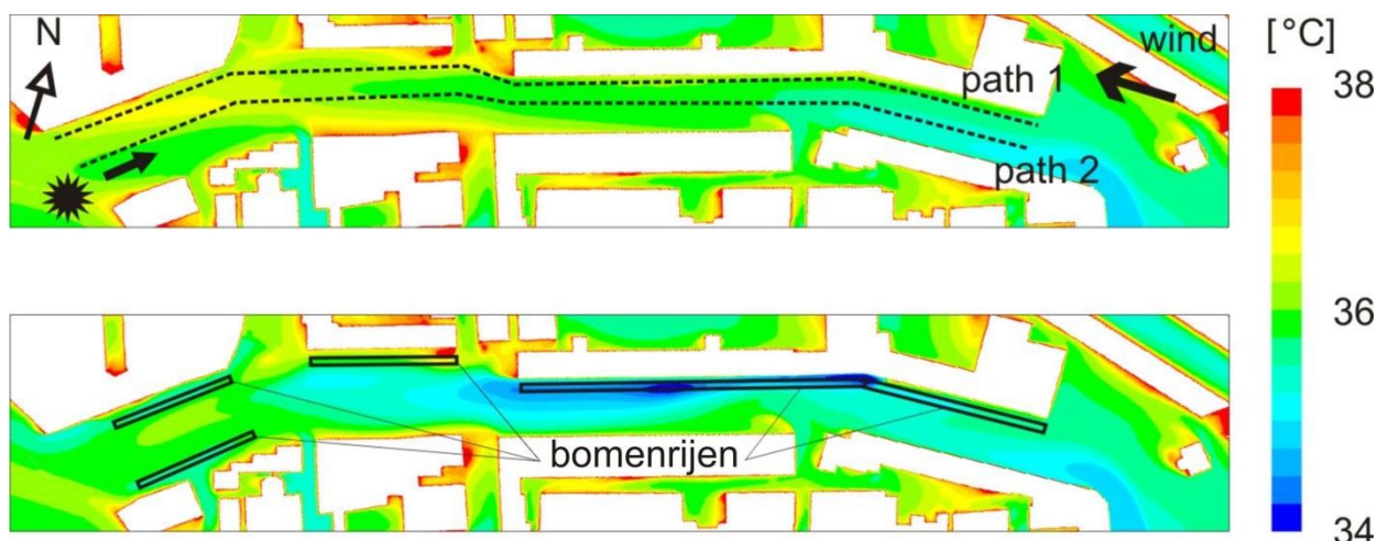
Figuur 3.7 Luchttemperatuur op voetgangershoogte (2 m boven de grond) in de J.P. van Muijlwijkstraat in Arnhem voor de huidige situatie (boven) en voor het scenario met bomenrijen in de gehele straat (onder). De bomenrijen zijn weergegeven door de zwarte rechthoeken (Gromke et al., 2015).
