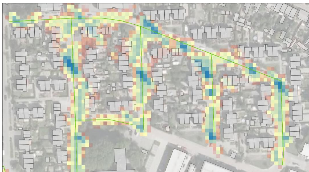
Figuur 12: Invloed van peilverlaging op grondwaterstand bij drainage (blauw 10 cm, oranje 3 cm)
