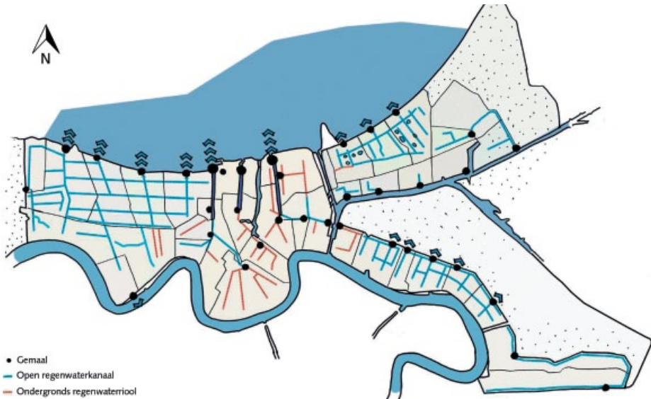
Figuur 12.4 Schematische weergave van het huidige hemelwaterafvoersysteem in New Orleans, bron: Waggonner & Ball Architects, 2013.
