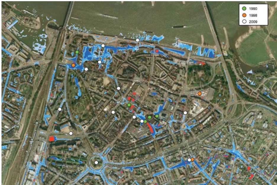
Figuur 16.4 Vergelijking neerslaggebeurtenissen centrum Nijmegen met 2D-modellerig (Bron: Grontmij, Wodan-2D-analyse 24-9-13).
