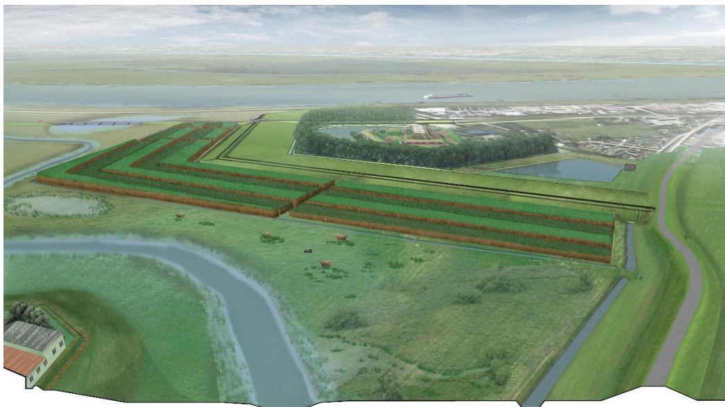
Impressie van het golfremmend griend in polder Noordwaard (bron: Robbert de Koning)
