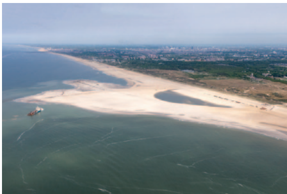
Dynamisch kustbeheer in de vorm van 'zandmotor'
