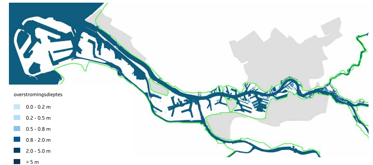
Kaart 1: Overstromingsbeeld buitendijks Rotterdam 2015 (bron: Deltares) met een herhalingsjijd van 1 x 1.000 jaar
