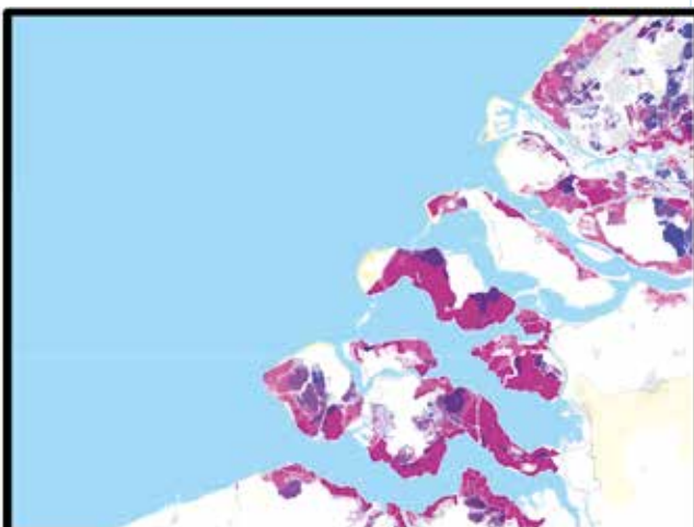
Figuur 2. De snelheid van overstromen en de maximale waterdiepte bij overstromen na een dijkdoorbraak voor de Zuidwestelijke Delta (Bron: Conceptkaart Deltares vervaardigd i.k.v. risicozonering, in: Klijn et al., 2012, blz. 119).
