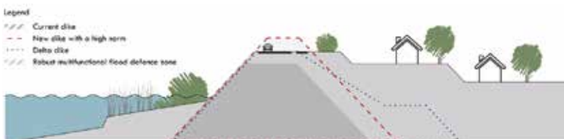
Figuur 5. Dwarsdoorsnede van een traditionele dijk, een traditionele dijkversterking, een deltadijk en een robuuste, multifunctionele waterkeringszone (Bron: Van Loon - Steensma en Vellinga, 2014 xxxiii ).
