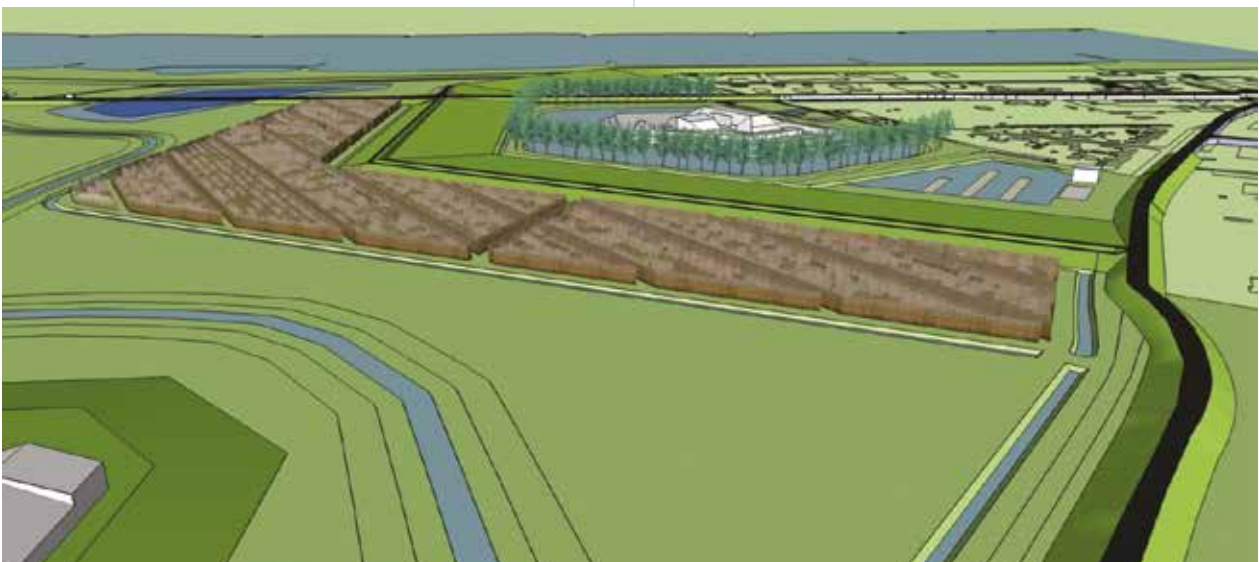
Figuur 12. Door begroeiing aan te plannen voor een dijk hoeft de dijk minder hoog te worden omdat de begroeiing een deel van de energie van de golven dempt. Deze tekening toont de situatie die in de Noordwaard zal worden gerealiseerd: de begroeiing in het ontpolderde deel van de Noordwaard (linksonder) dempt de golfwerking op de dijk rond de verkleinde dijkkring rond het Steurgat (rechtsboven) (Bron: Mindert de Vries, Deltares).
