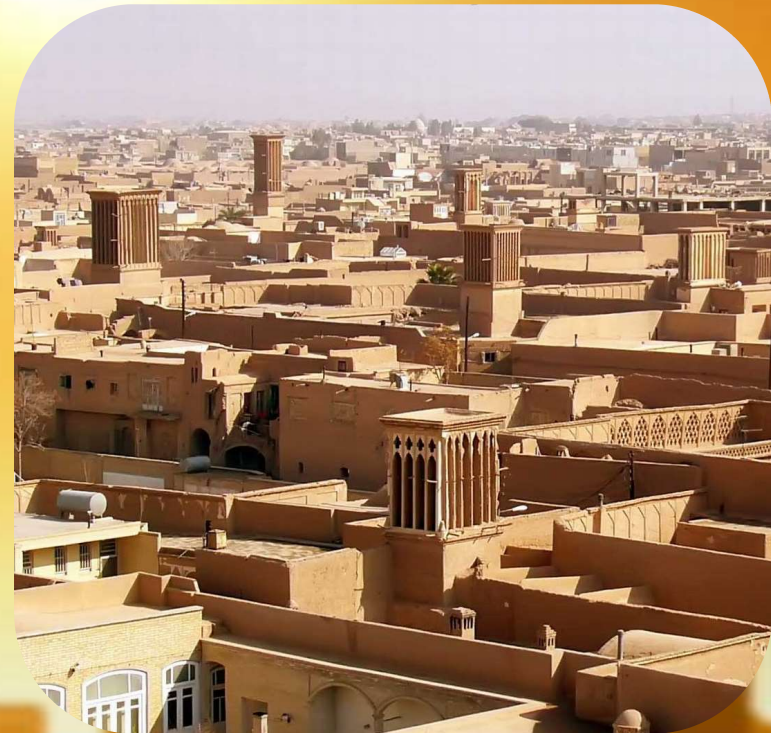
Windkokers voor ventilatie met hulp van de woestijnwind in Yazd - Iran.
