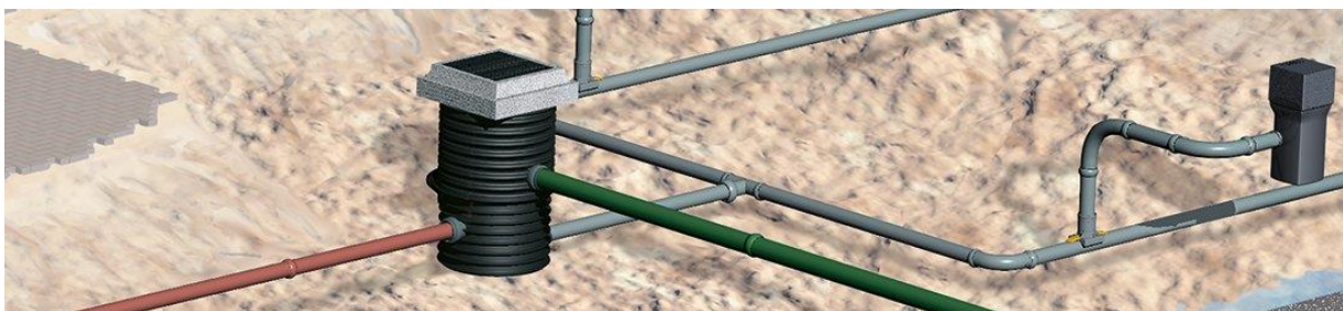
Figuur 23. Een schematische weergave van hoe een smartdrain op het leidingnetwerk bevestigd wordt (Wavin, Put Smart Drain, sd)
