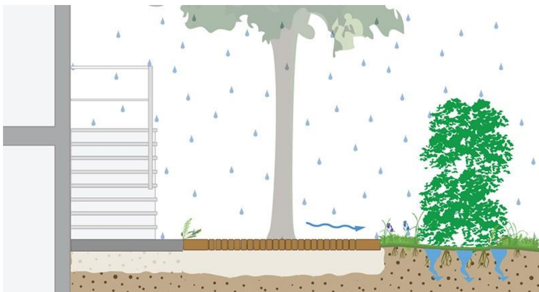
Figuur 13 Schematische doorsnede van een groene erfafscheiding. (Merlijn Michon, 2017)
