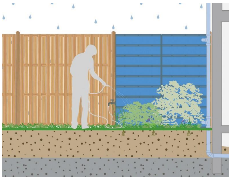
Figuur 26 Schematische doorsnede van een regenwaterschutting. (Rainproof, 2017)
