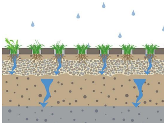
Figuur 2: Grasbetonsteen infiltratie (Rainproof)
