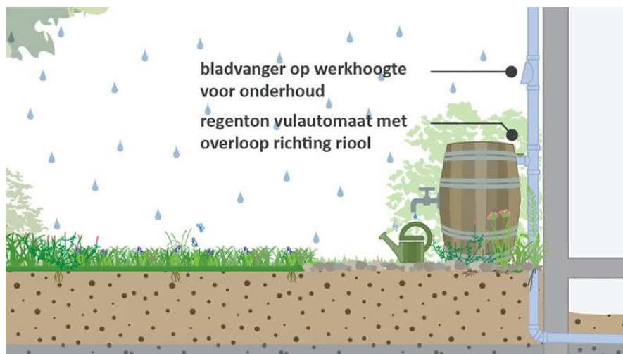
Figuur 25: Schematische doorsnede van een regenton. (Rainproof)
