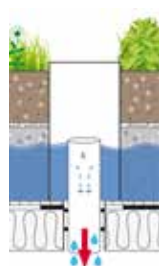
Schematische doorsnede retentiedak ©Optigroen
