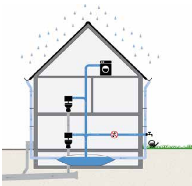
Schematische doorsnede regenwatergebruik-systeem met waterzak © Atelier GROENBLAUW
