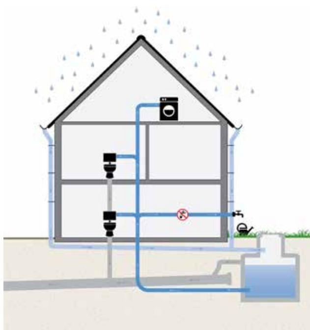
Schematische doorsnede regenwater-gebruikssysteem © Atelier GROENBLAUW
