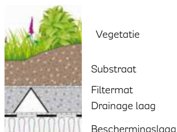
Schematische doorsnede natuurdak ©Optigroen
