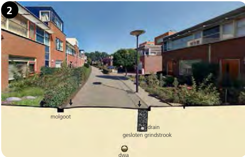
Variant 2: grindgoot en wadi
