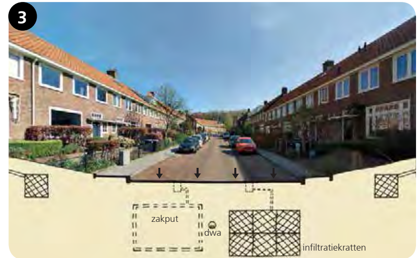
Variant 3: ondergrondse berging - groot
