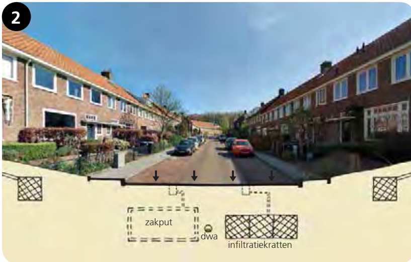
Variant 2: ondergrondse berging
