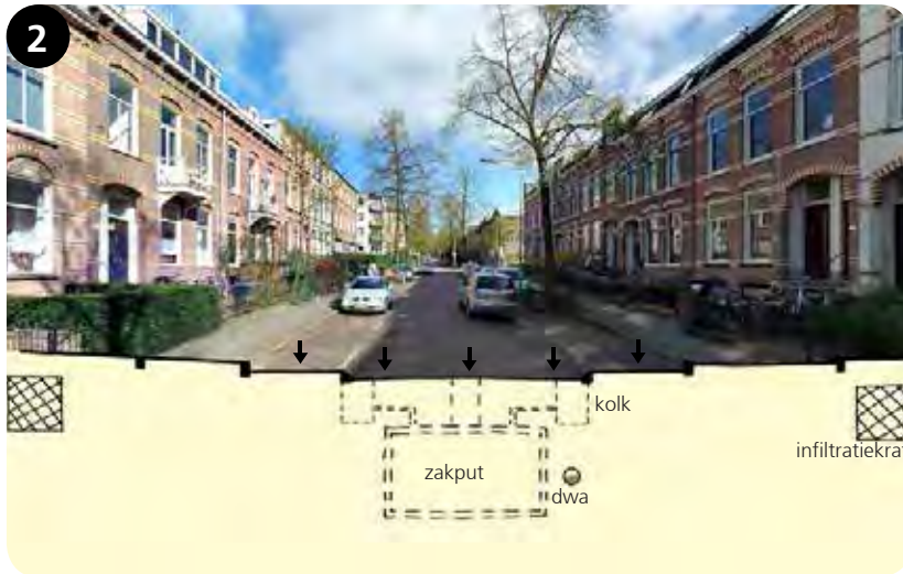
Variant 2: ondergrondse berging
