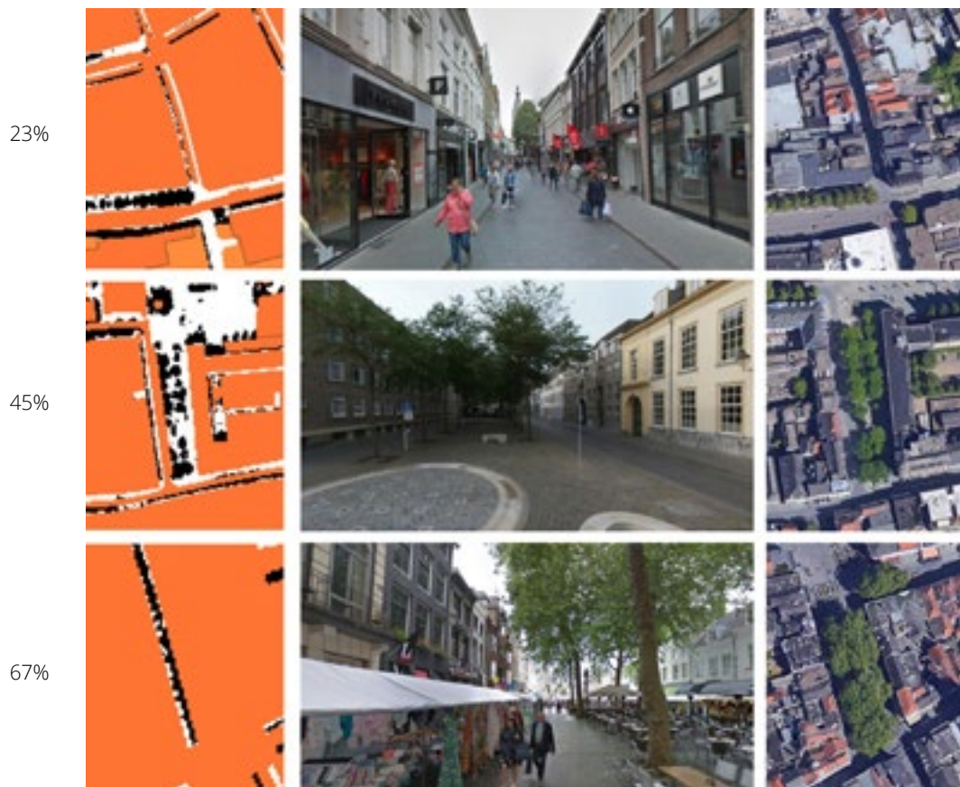
Figuur 4.11 Percentage schaduw op loopgebieden op 21 juni om 14:00 uur, met per straat het resultaat van de schaduwanalyse (links) – wit is loopgebied, zwart is schaduw, oranje is overig – en een foto op ooghoogte (midden) en vanuit de lucht (rechts).
