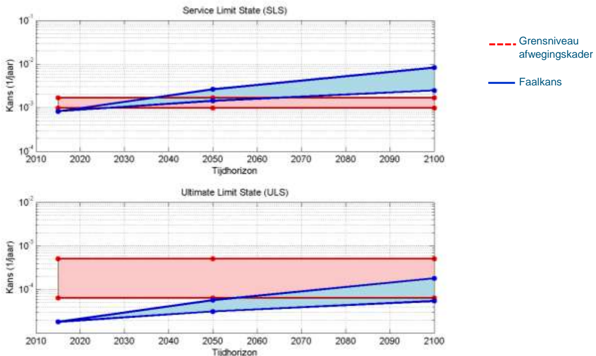
Figuur 28. Afweging overstromingsrisico nutsbedrijven aan de hand van SLS (boven) en ULS (onder). De blauwe vlakken geven de bandbreedte aan als gevolg van het klimaatscenario met als bovengrens het W+ klimaatscenario en als ondergrens het G klimaatscenario; het rode vlak geeft de acceptabele faalkans op basis van het huidige 'afwegingskader Pilot Botlek'.
