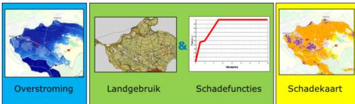
Figuur 2. Schematische weergave methode bepaling directe schade (Bron: Nicolaï et al, 2016)
