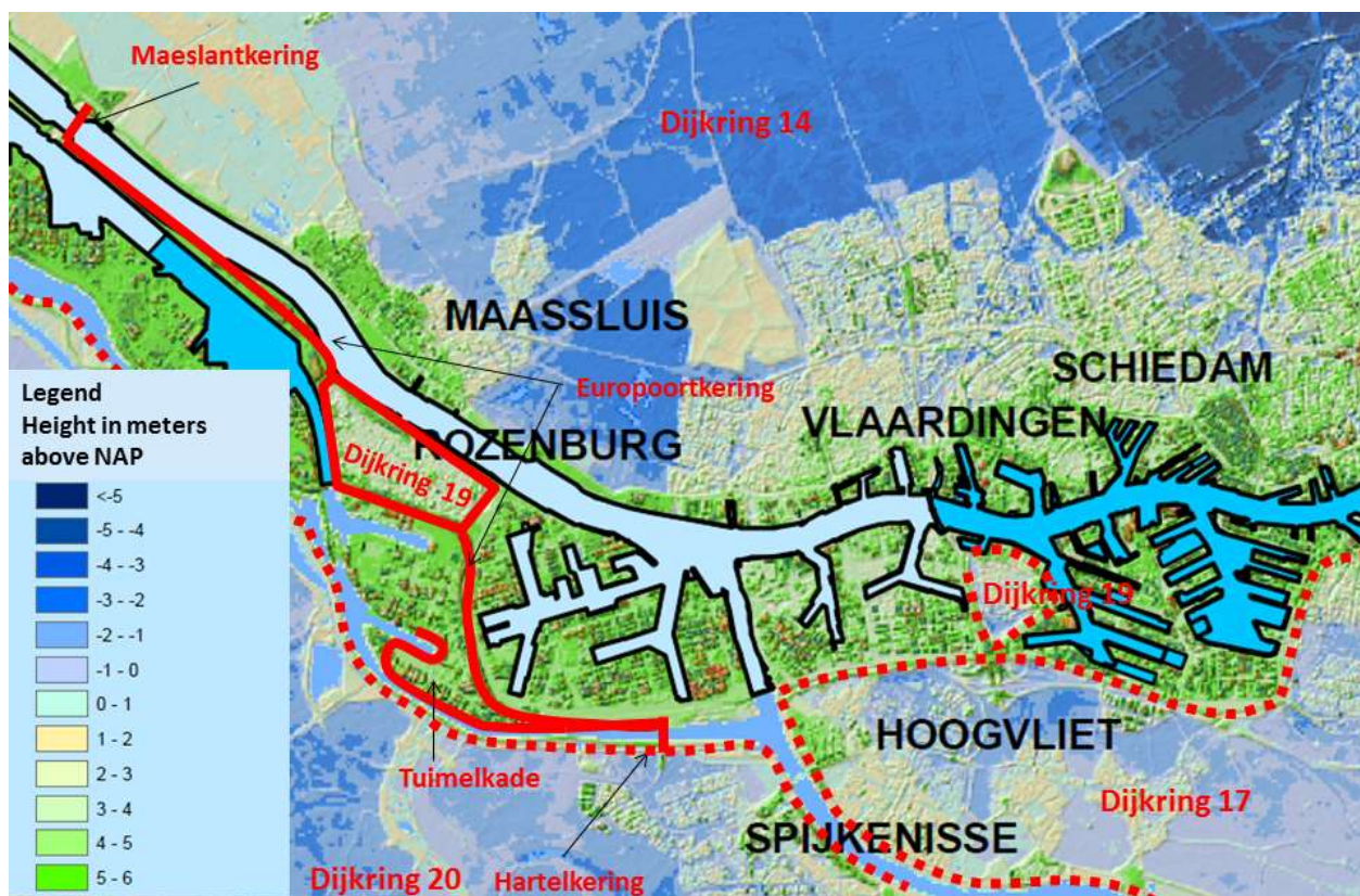
Figuur 8. Waterveiligheidssituatie rondom het pilotgebied Botlek. In rood zijn relevante waterkeringen voor het Pilotgebied Botlek aangegeven zoals de Hartelkering, de Europoortkering, de Tuimelkade, de waterkering rondom Rozenburg en de Maeslantkering. De kleurschaal geeft een indruk van de hoogte van het gebied t.o.v. NAP.
