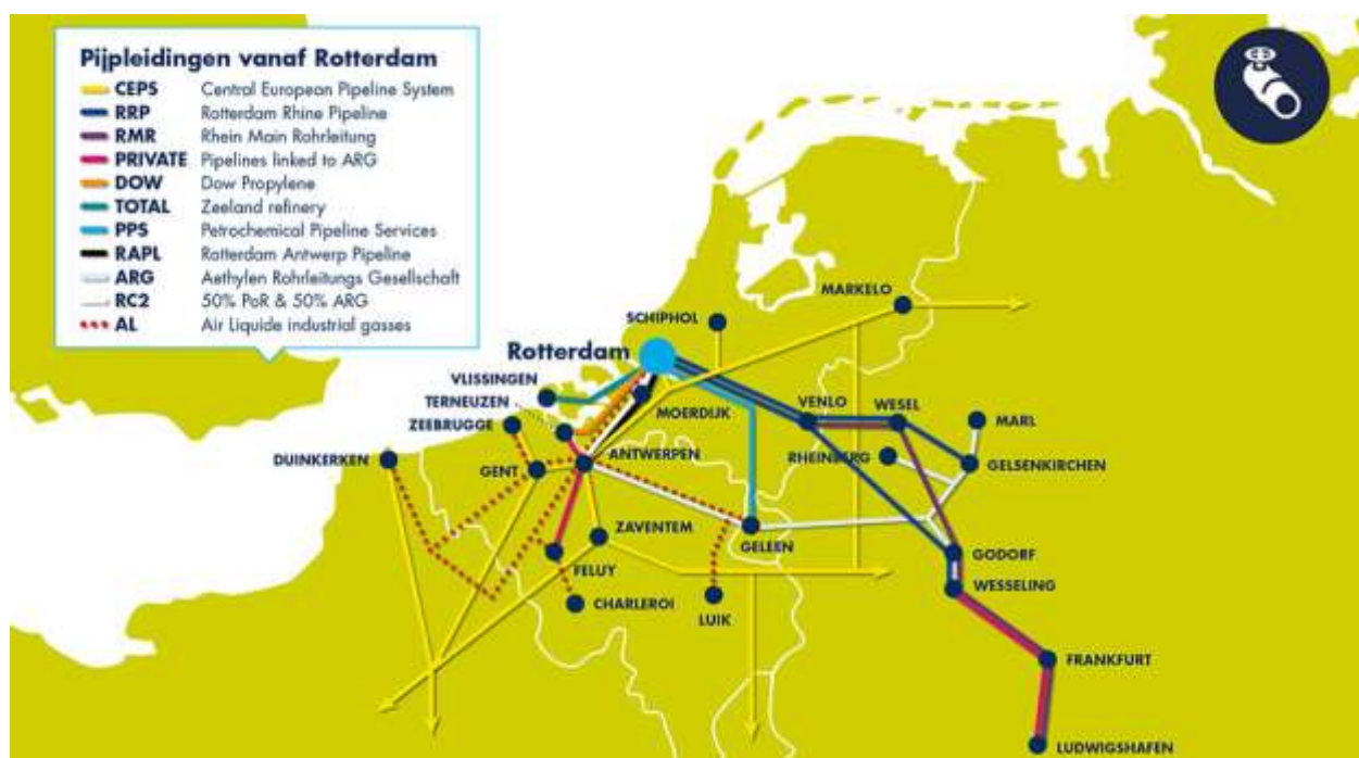
Figuur 7. Pijpleidingen vanaf Rotterdam (Bron: Havenbedrijf Rotterdam).
