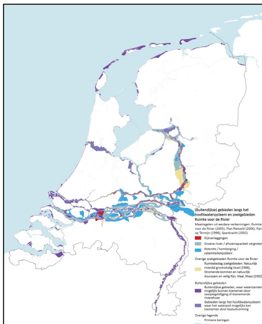
Figuur 3.6 Kaartbeeld met (buitendijkse) gebieden langs het hoofdwatersysteem die mogelijk te maken krijgen met hogere waterstanden ten gevolge van zeespiegelstijging en veranderingen in rivierwaterafvoeren. De kaart laat ook zoekgebieden voor Ruimte voor de Riviermaatregelen zien vanuit verschillende eerdere studies zoals de blokkendoos PKB en Maas en de spankrachtstudie 14
