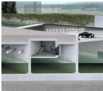
Ondergrondse waterberging in tijden van hevige wateroverlast - garage museumpark Rotterdam
