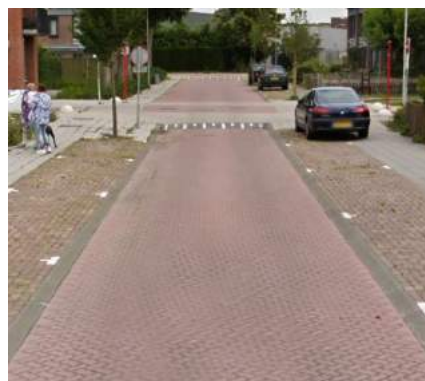
Inzet van drempels en stoepranden ter compartimentering voor tijdelijke waterberging op straat
