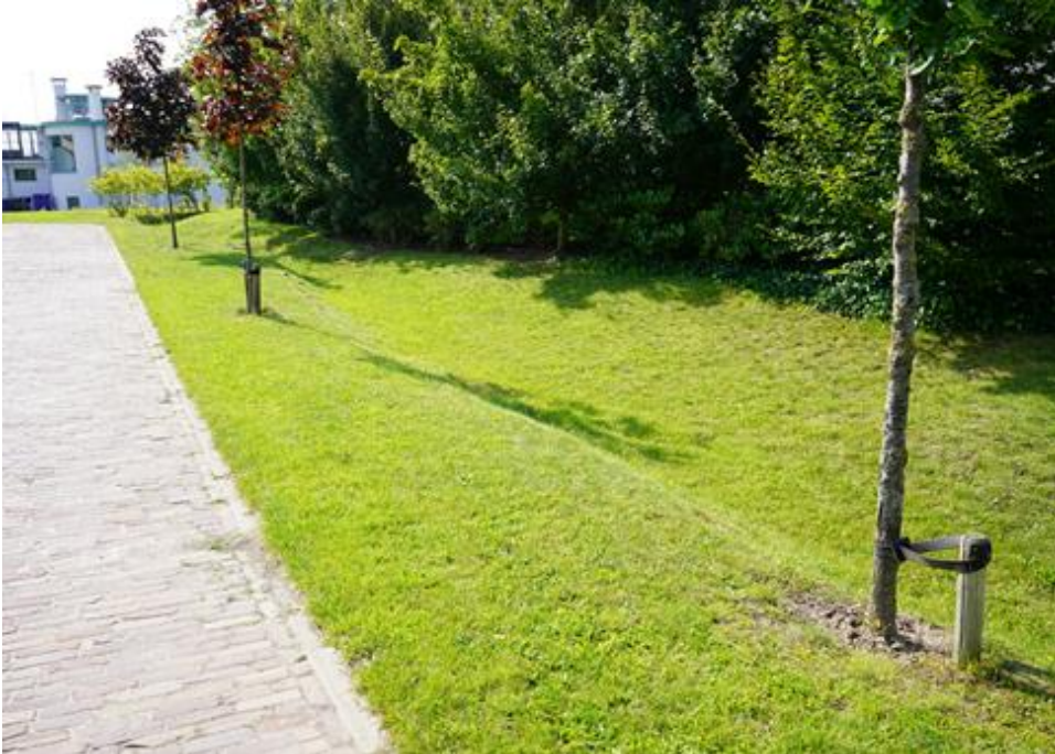
Figuur 9 Voorbeeld van een wadi (bron: Nanda Sluijsmans).
