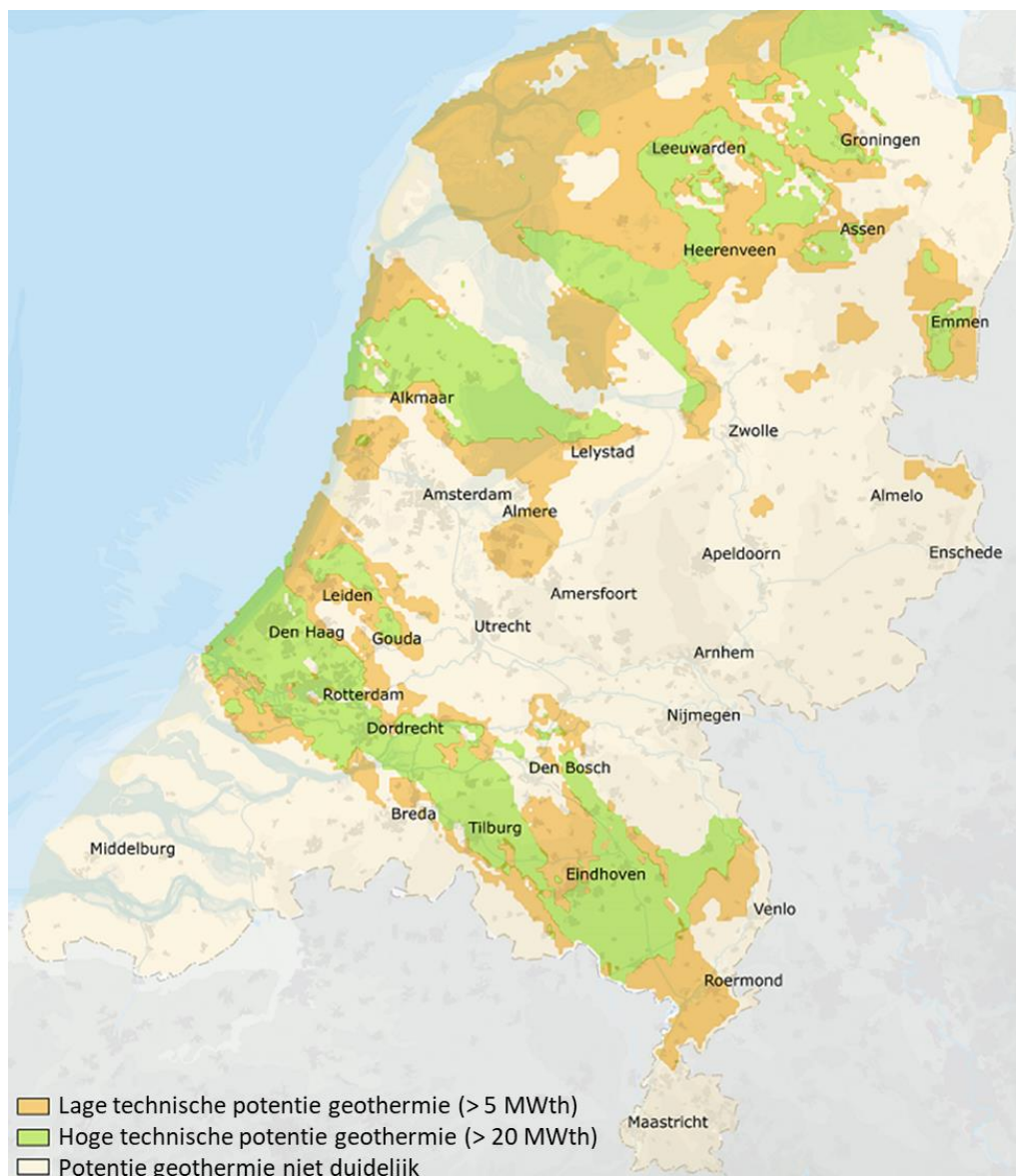
Figuur 5.5: Technische potentie geothermie) Bron: TNO via ThermoGIS ( www.thermogis.nl , versie oktober 2022) Gebieden met potentie geothermie niet duidelijk betekent de gebieden waar nog geen onderzoek is gedaan naar potentie geothermie.
