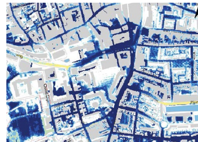
WATERDIEPTE BIJ KORTDURENDE HEVIGE NEERSLAG VOOR HET JAAR 2050. BOVEN: EENS IN DE 100 JAAR (70MM IN 2 UUR). ONDER: EENS IN DE 1000 JAAR (140MM IN 2 UUR) (KLIMAATEFFECTATLAS 2019)
