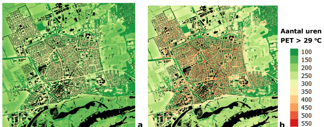
Figuur 3.17: PET-Overschrijdingskaarten overdag. Aantal uren dat de PET groter is dan 29\text{ }^{\circ}\text{C} in 2013 (april tot en met september) met de meteorologie van het referentiestation Herwijnen. a) huidig klimaat, b) toekomstig klimaat 2050, translatie naar het WH-scenario.
