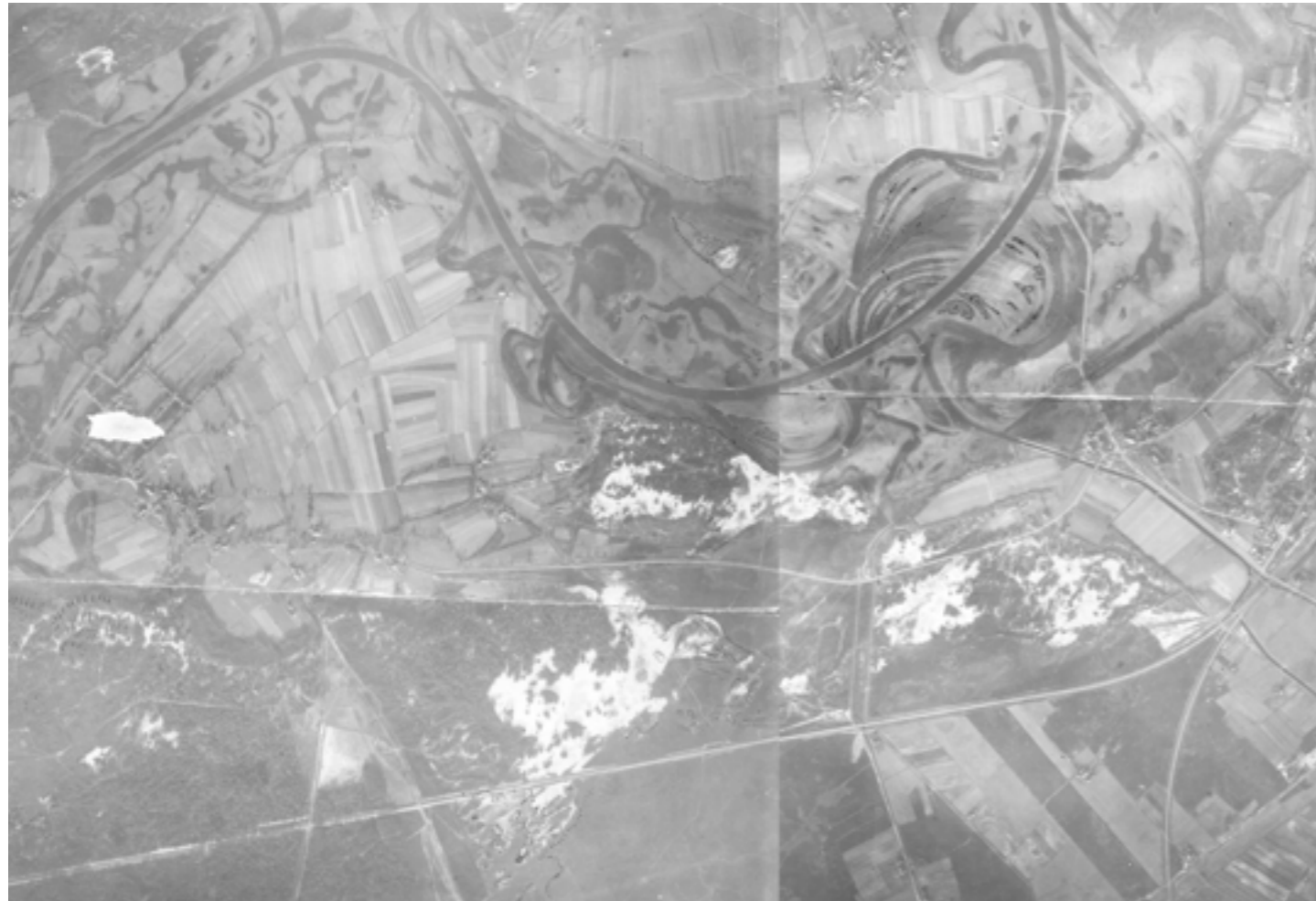
Afb. 1.5 - Langs de Vecht bij Beerze en Junne zijn in de eerste helft van de twintigste eeuw de oude Vechtmeanders doorgegraven, zodat er een snellere vaarroute en waterafvoer gerealiseerd kon worden. Op deze luchtfoto uit de jaren dertig zijn de oude meanders en hun kronkelwaarden nog heel goed te zien.
