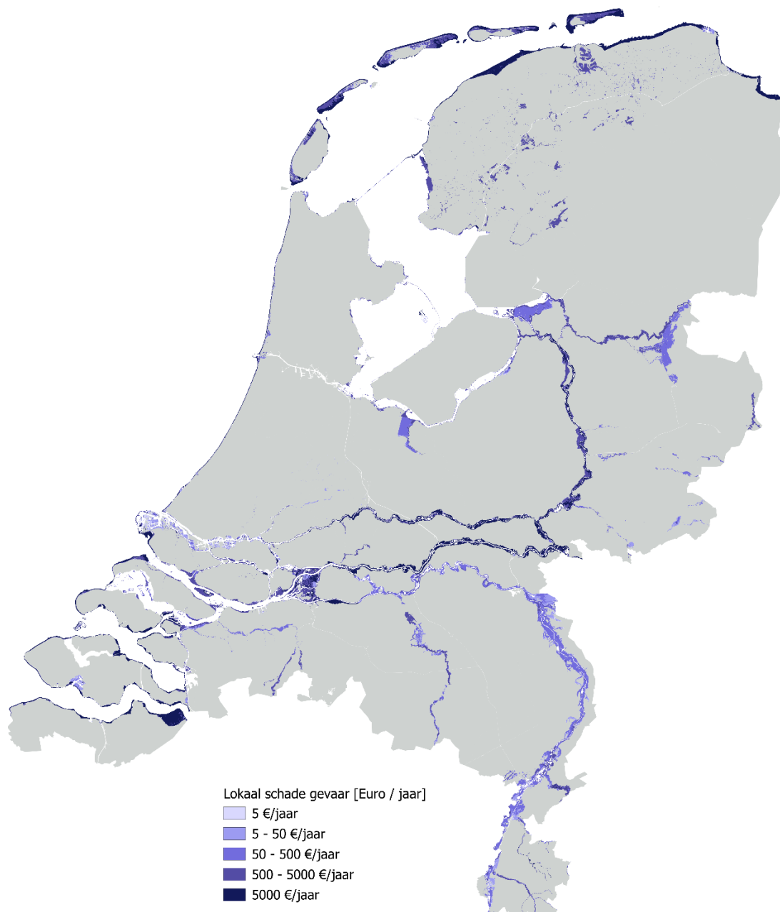
Figuur 3-9 Lokaal Schadegevaar behorend bij overstromingen in de buitendijkse gebieden (gebaseerd op data uit LIWO, gemaakt in Oktober 2024).
